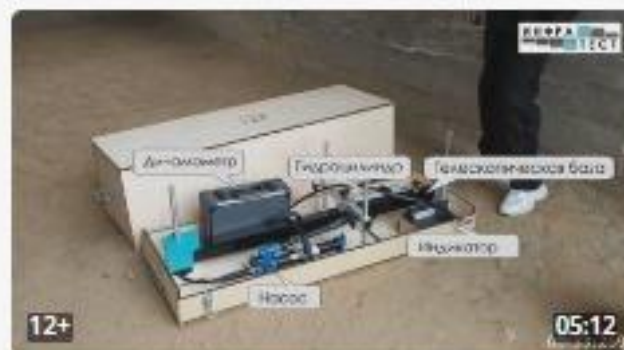
Статический прибор Инфратест для определения модуля деформации...
