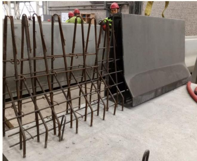
Несъемная опалубка блоков тип Нью-Джерси из СПФБ для мостовых конструкций
