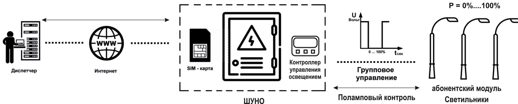
АСУНО PLC-light позволяет удаленно менять мощность/световой поток ОП\* в группе, измерять мощность каждого ОП\* и определять на какой опоре и с каким номером вышли из строя ОП\* (осветительный прибор).
