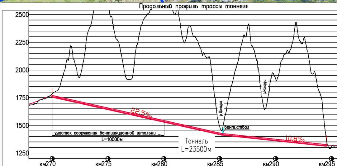
План и продольный профиль тоннельного комплекса, входящего в состав автомобильной дороги от села Эстосадок до поселка Пхия
